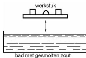
figuur 8 Principe van het zoutbad solderen
