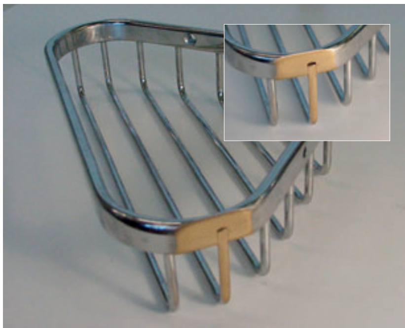
Figuur 4 - Het zeepbakje is een goed voorbeeld waar een lijmverbinding kostentechnisch een duidelijk voordeel biedt ten opzichte van een soldeerverbinding. Ondanks de continue belasting van allerlei producten in een agressief - vochtig en basisch milieu - blijkt deze verbinding probleemloos te voldoen.
